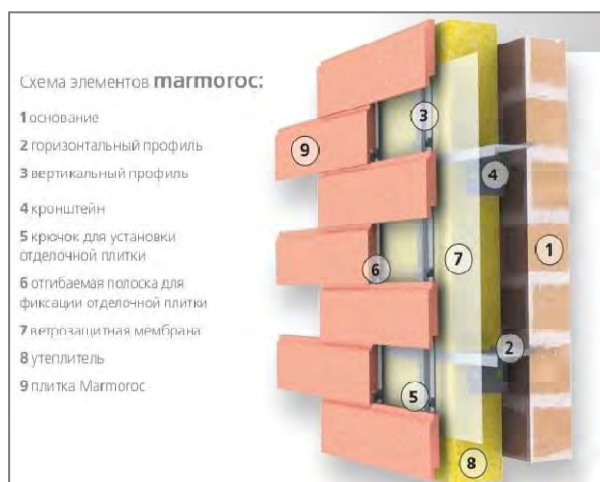
Рисунок І.3.2. Схема елементів системи «Marmoros»
