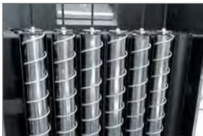
Рисунок С.2. Зовнішній вигляд диску з пластинами для очищення теплообмінника.
