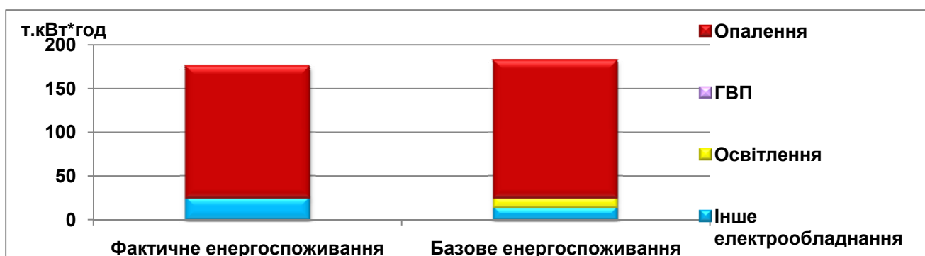
Рисунок 6.2.2. Споживання енергії будівлею
