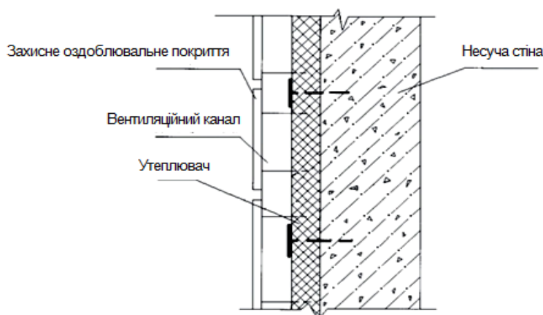
Рисунок 7.1.3. Утеплення стін за методом «керамічний вентиляований фасад»
