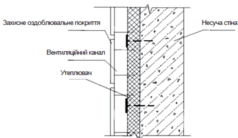
Рисунок 7.1.3. Утеплення стін за методом «керамічний вентиляований фасад»
