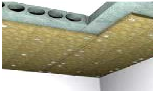
Рисунок 7.1.5. Приклад утеплення перекриття зі сторони підвалу
