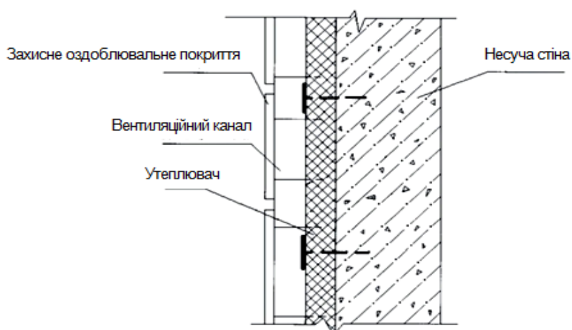
Рисунок 7.1.3. Утеплення стін за методом «керамічний вентиляований фасад»
