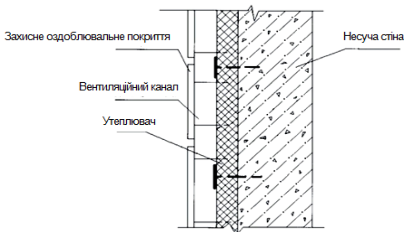
Рисунок 7.1.3. Утеплення стін за методом «керамічний вентиляований фасад»
