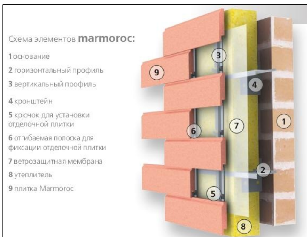
Рисунок Схема елементів системи «Marmoroc»
