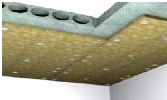
Рисунок 7.1.7. Приклад утеплення перекриття зі сторони підвалу
