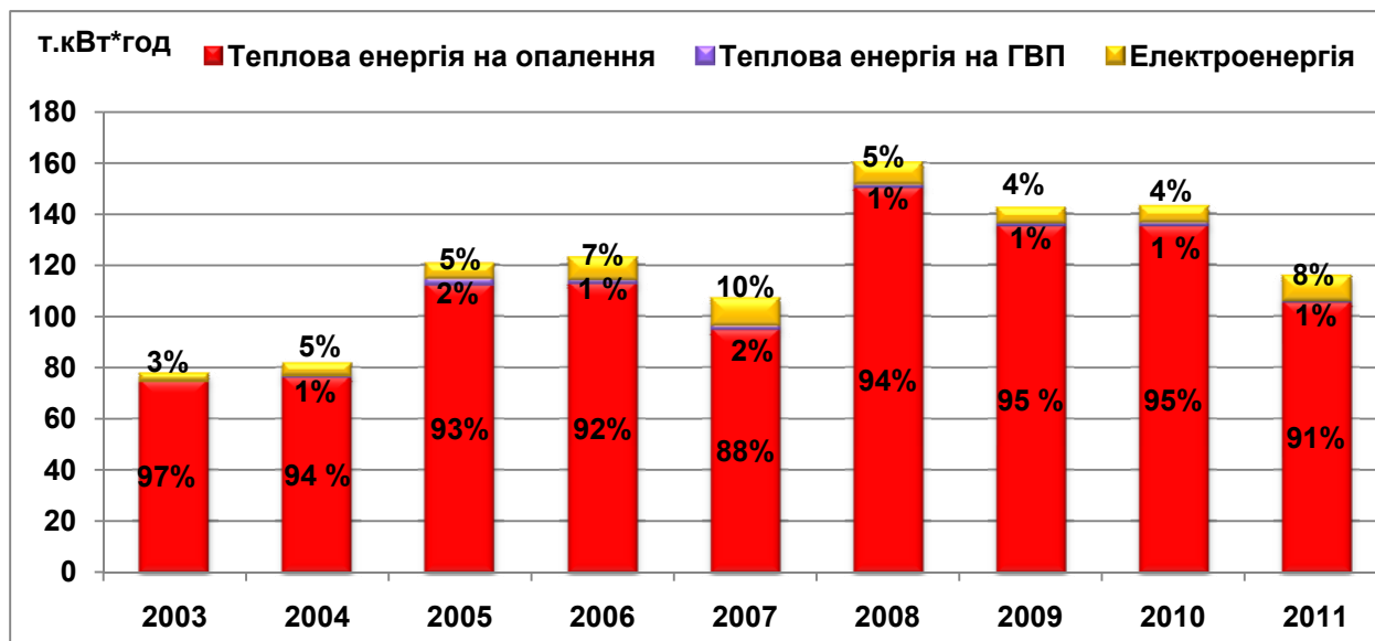
Рисунок 6.1.1. Структура споживання енергії будівлею
