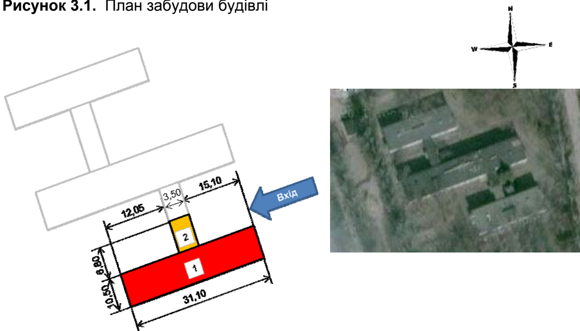
Рисунок 3.1. План забудови будівлі
