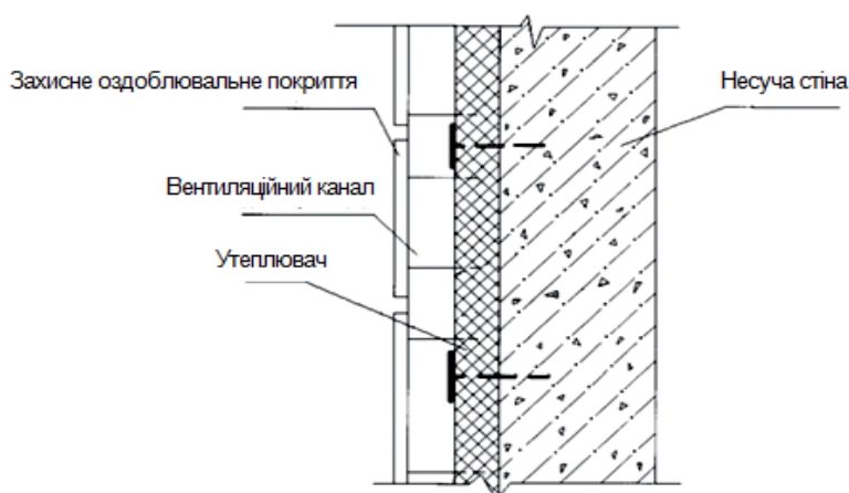
Рисунок 7.1.3. Утеплення стін за методом «керамічний вентиляований фасад»
