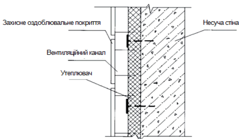
Рисунок 7.1.3. Утеплення стін за методом «керамічний вентиляований фасад»
