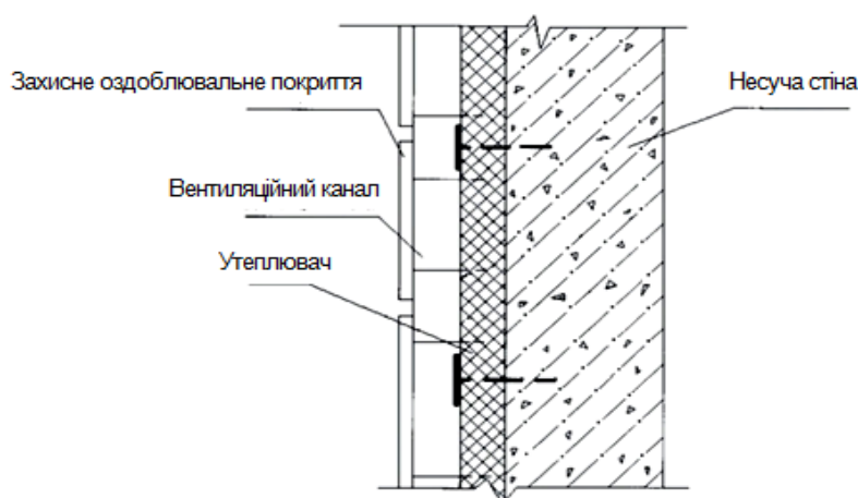
Рисунок 7.1.3. Утеплення стін за методом «керамічний вентиляований фасад»
