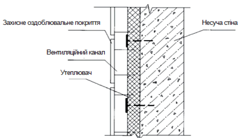
Рисунок 7.1.3. Утеплення стін за методом «керамічний вентиляований фасад»
