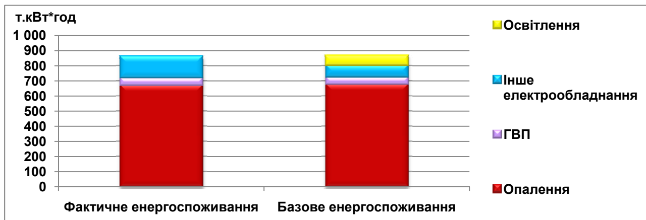
Рисунок 6.2.2. Споживання енергії будівлею поліклініки
