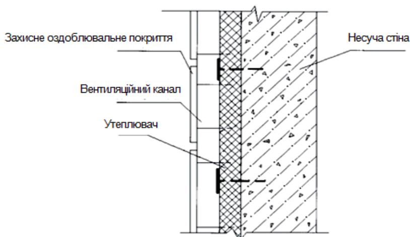
Рисунок 7.1.3. Утеплення стін за методом «керамічний вентиляований фасад»
