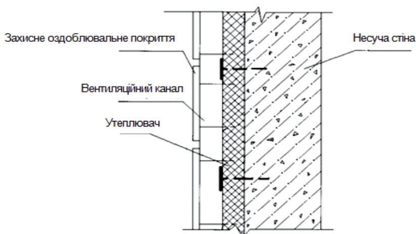
Рисунок 7.1.3. Утеплення стін за методом «керамічний вентиляований фасад»
